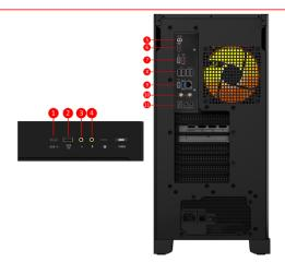
1. 1x USB 5Gbps Typ C 3. 1x Kopfhörerausgang 5. Flash Bios Button / Clear CMOS
