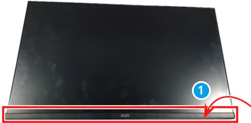
2. Setzen Sie die Schrauben **2** wieder ein und ziehen Sie sie mit einem Kreuzschlitzschraubendreher fest, um den Dekorstreifen an der LCD-Blende zu befestigen.
