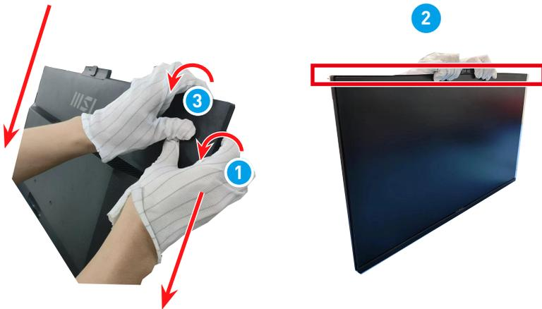
2. Hebeln Sie die Unterseite der hinteren Abdeckung vorsichtig mit einem Hebelwerkzeug ab.
