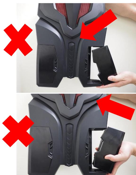
请水平对齐插槽卡榫后再安装电池。
