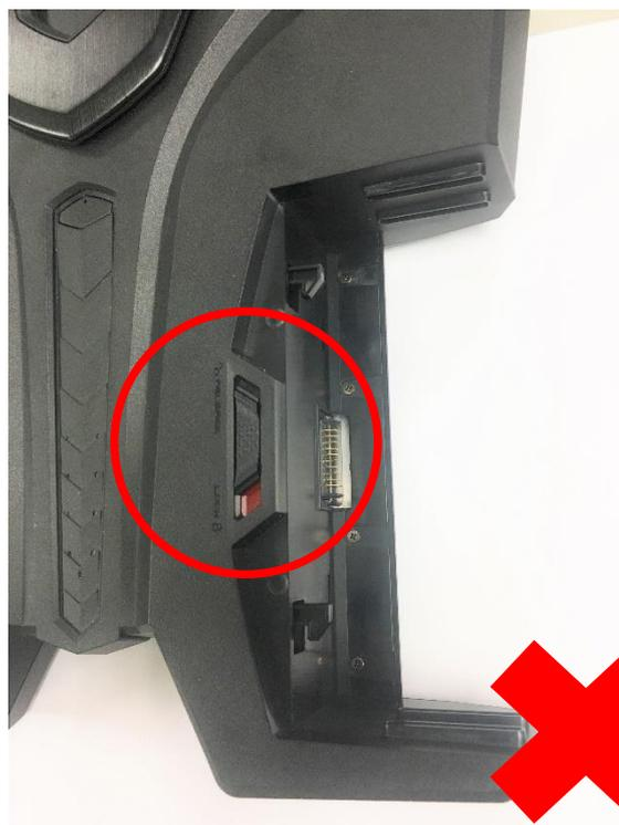
将电池锁开关朝 LOCK 方向下拉，使电池锁卡勾能回归到正确位置。
