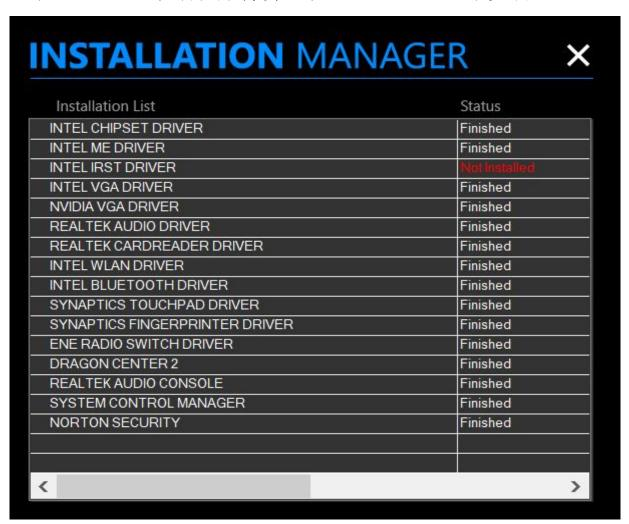
附注:若预安装的系统上带有 IRST 驱动程序或在试着执行 Intel RST 快速存储技术应用程序时出现错误讯息 "IRST 驱动遗失或未被正确安装",请手动移除 IRST 驱动程序。
