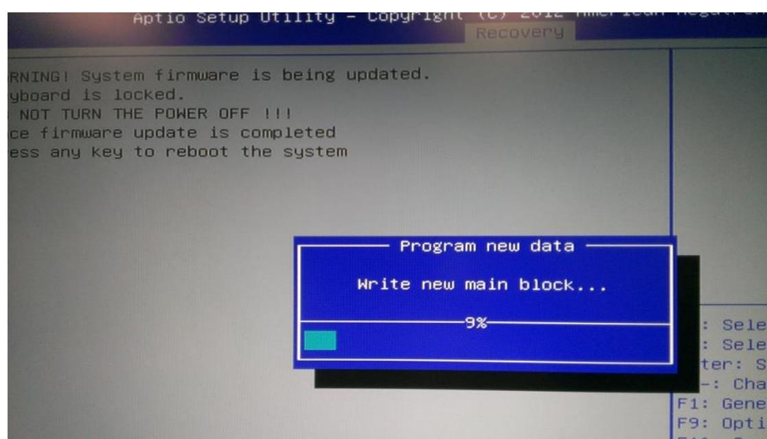
O. 在第一次成功更新 BIOS 后, 为了完整更新 Intel 处理器的微指令版本 (Microcode), 请重复步骤 E - 步骤 N再进行一次 BIOS 更新。
